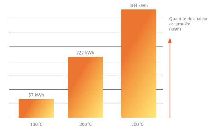
Plus la température à laquelle peut être chauffé le matériau de la chambre de combustion est élevée, plus importante sera la quantité d'énergie absorbée et stockée. La quantité de chaleur (kWh) accumulée par mètre cube (m<sup>3</sup>) de pierre ollaire selon les températures (Source: adapté selon VTT-S-05448-06)
