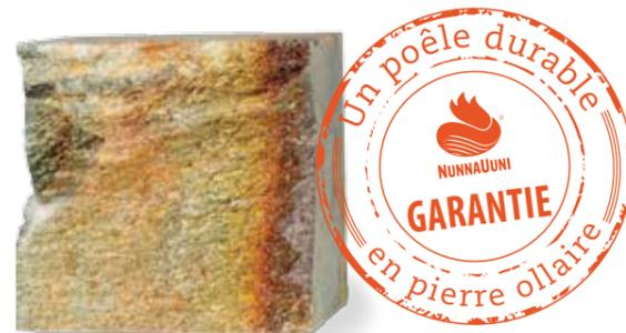
La couche de périclase qui se forme à la surface de la pierre ollaire Mammutti est le garant de la durabilité de la chambre de combustion.
