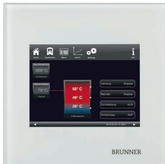
Commande électronique des poêles EOS. Automatisation de l'air de combustion avec toutes les fonctions supplémentaires requises pour les cheminées et poêles modulaires à conduites d'eau.
